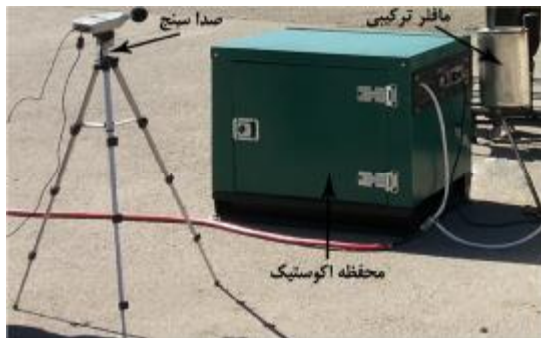
شکل ۳- موتور ژنراتور مجهز به مافلر ترکیبی پوشانده با محفظه آکوستیک به همراه صداسنج
