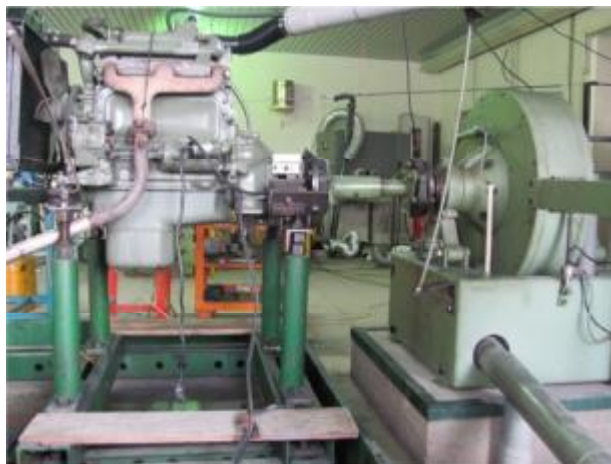
شکل ۱- دینامومتر مورد استفاده در آزمایش‌ها به همراه موتور تحت آزمایش (منظور همان موتور OM314)
