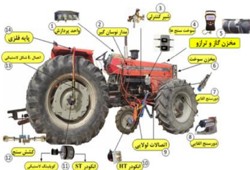
شکل ۳- تراکتور مسی فرگوسن ۳۹۹ مجهز به سیستم سوخت ترکیبی (گازوئیل و گاز مایع نفتی): (۱) واحد پردازش؛ (۲) مدار نوسانگیر؛ (۳) شیر کنترل؛ (۴) سوخت‌سنج؛ (۵) مخزن سوخت گاز و ترازوی سنجش سوخت؛ (۶) مخزن سوخت؛ (۷) دورسنج القایی؛ (۸) دورسنج القایی؛ (۹) اتصالات لولایی؛ (۱۰) انکودر HT؛ (۱۱) انکودر ST؛ (۱۲) کشش‌سنج؛ (۱۳) اتصالات لاستیکی؛ و (۱۴) پایه فلزی
