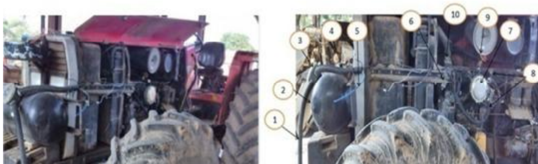
شکل ۱- نحوه قرار گرفتن تجهیزات سیستم سوخت ترکیبی گازوئیل و گاز LPG بر روی تراکتور مسی فرگوسن ۳۹۹ (۱) لوله تزریق گاز به داخل مخزن؛ (۲) مخزن؛ (۳) سوپاپ ایمنی و گیج فشار گاز داخل مخزن؛ (۴) لوله فشار قوی انتقال گاز؛ (۵) تخلیه گاز؛ (۶) شیرالکتریکی قطع و وصل جریان گاز؛ (۷) ریگلاتور؛ (۸) لوله‌های انتقال آب موتور به ریگلاتور؛ (۹) شیر مکانیکی؛ و (۱۰) میکسر
