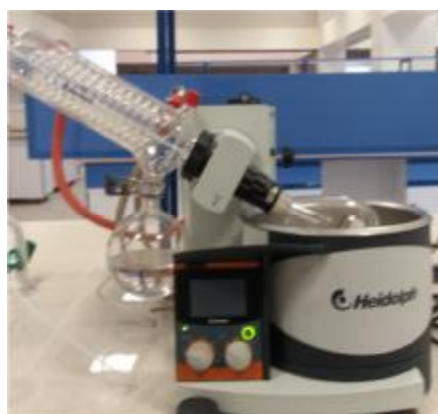
شکل ۲- بازیابی حلال از مخلوط روغن و حلال توسط دستگاه تقطیر دوار خلأ
