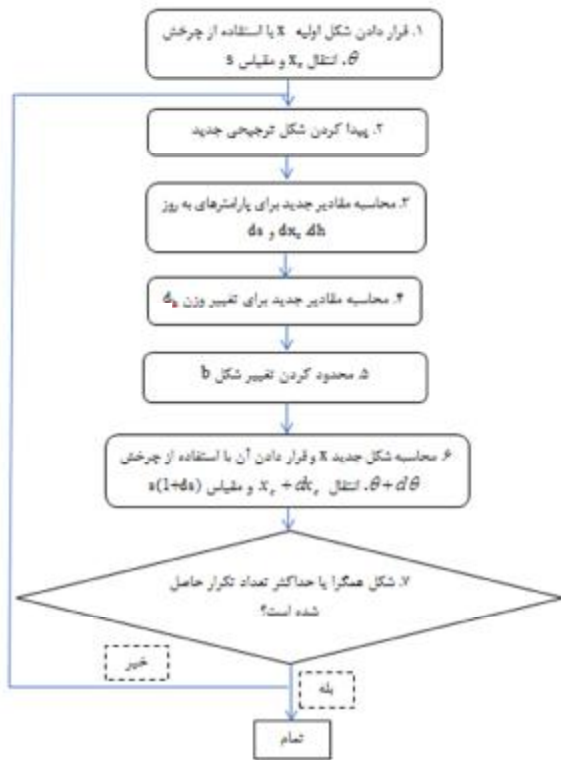
شکل ۲- فلوجارت مراحل مختلف فرآیند جست‌وجو مدل شکل فعال
