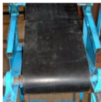
شکل ۲- سطح شیب‌دار انتقال قلمه به موزع
