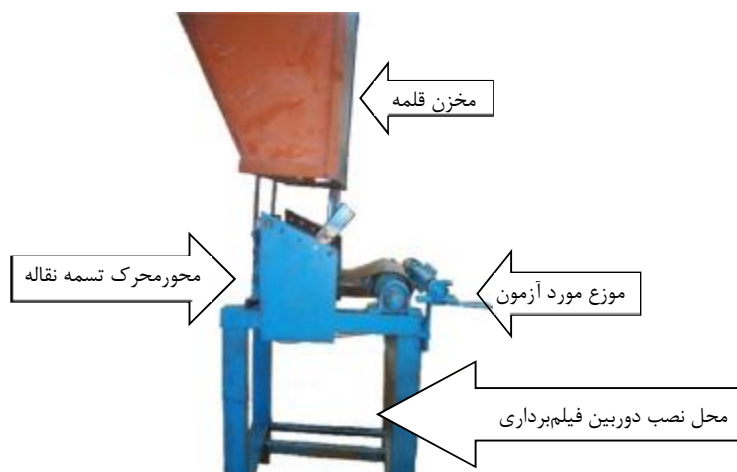
شکل ۱- دستگاه ساخته شده برای شبیه‌سازی قلمه‌کاری نیشکر
