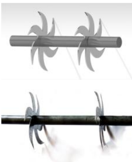
شکل ۴- موزع چرخ ستاره‌ای: تصویر مدل رایانه‌ای (بالا) و ساخته شده (پایین)
