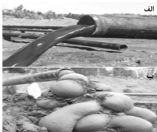
شکل ۸- باطله فرآوری مواد معدنی در دو حالت الف) اسلاری و ب) باطله خمیری (Crowder، ۲۰۰۳)
