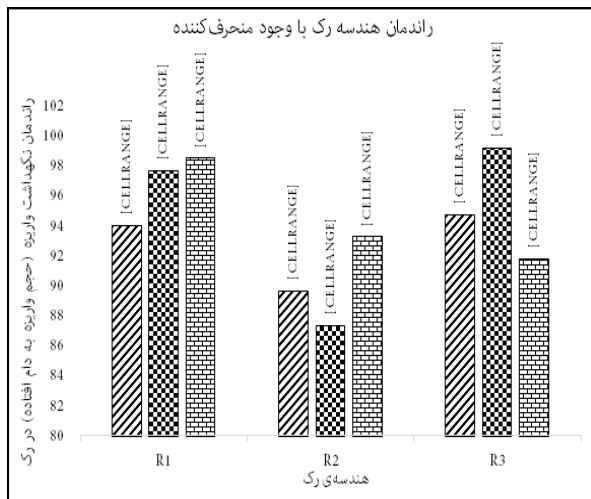
شکل ۷- بررسی تأثیر همزمان هندسه آشغال‌گیر و منحرف‌کننده‌ها در شرایط جریان فوق بحرانی بر راندمان نگهداشت واریزه در رگ O1، O2 و O3 به ترتیب سایزهای کوچک، متوسط و بزرگ نیم‌گویی‌ها می‌باشند.
