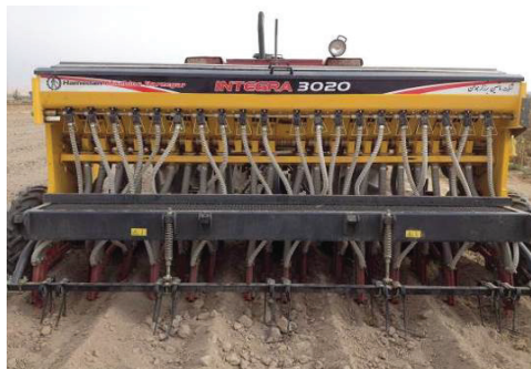
شکل ۲- خطی کار کف کار ۲۰ ردیفه برای کاشت در داخل شیار آبیاری
