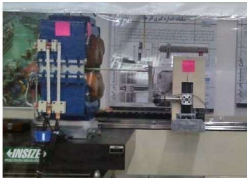
شکل ۱. میز اندازه‌گیری مغناطیسی در داخل اتاقک کنترل دما.
