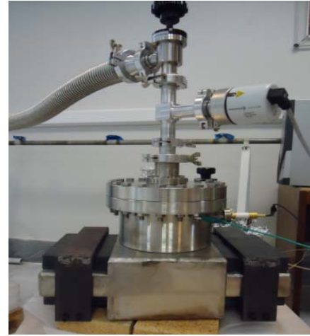
شکل ۱۲. پمپ یونی ساخته شده در شتاب دهنده ملی ایران.
