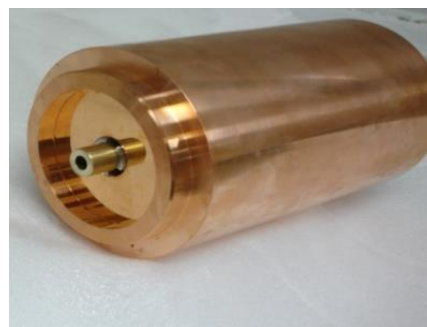
شکل ۵. کاواک ۹ سلولی ساخته شده با استفاده از روش انقباضی.
