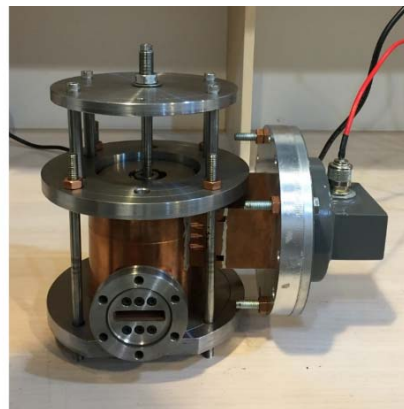
شکل ۸. نقشه مکانیکی ساختار قید و بند تنظیم بسامد نوسان (چپ) و ساختار قید و بند تنظیم بسامد نوسان نصب شده روی نمونه تست سرد تفنگ الکترونی بسامد رادیویی (راست).
