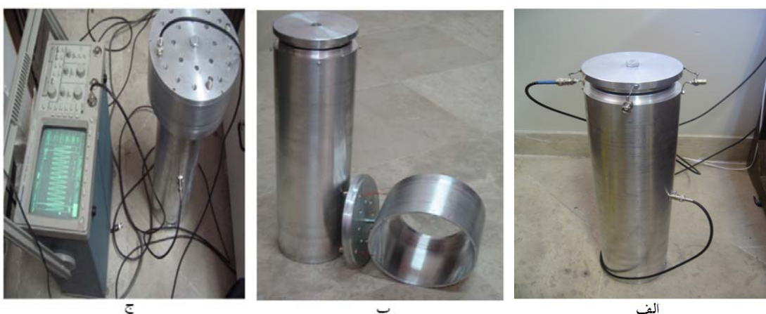
شکل ۵. تصاویری از کاواک هم‌محور آلومینیومی ساخته شده جهت تست‌های آزمایشگاهی طرح تزویج توان مستقیم.
