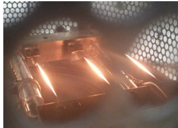
شکل ۵. تصویری از فیلمان‌های گداخته هنگام عبور جریان و گسیل الکترون.
