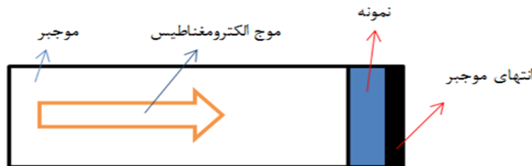
شکل ۴. (رنگی در نسخه الکترونیکی) طرح موجبر مورد استفاده برای اندازه‌گیری اتلاف بازتابی.
