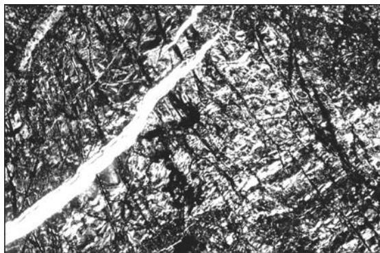
شکل ۷- مقطعی از یک سرپانتینیت که توسط رگه های کریزوتیل قطع شده است.
