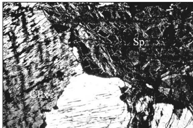
شکل ۶- مقطعی از متاهارزبورگیت که بلورهای برونزیت و سرپانتین را می‌توان در آن دید.
