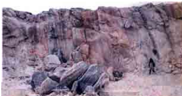
شکل ۴ - تصویری از سینه کار غربی معدن ملحه، دید رو به غرب، لایه‌بندی اولیه در این توالی تبخیری نمکی به خوبی حفظ شده است.
