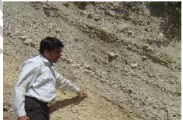
شکل ۲- آبرفتهای سازند A در تپه گیشا (شمال بزرگراه آیت ا... حکیم - انتهای کوی نصر)، شیب دار بودن آبرفت ها و وجود لایه های ماسه ای در این شکل مشاهده می شود (فروردین ۱۳۸۴).
