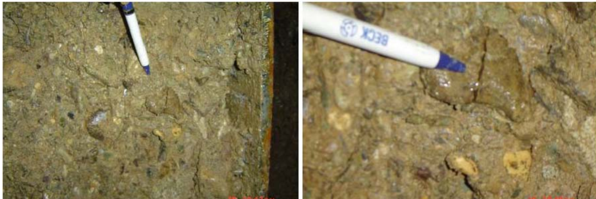
شکل ۲۲- شکسته شدن یک دانه در اثر اعمال تنش برشی در آزمون برش مستقیم برجا (محل انجام آزمایش در انتهای کوی نصر و در عمق ۱۳ متری از سطح زمین می باشد).
