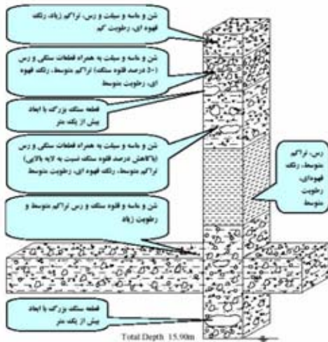
پروفیل خاک در محل شماره ۲ تا عمق ۱۶ متری
