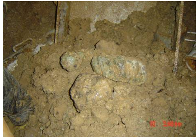
شکل ۱۸- وجود دانه های به شکل نیمه مدور در رسوبات سازند A تهران، عکس مربوط به انتهای کوی نصر و عمق ۷ متری می باشد.
