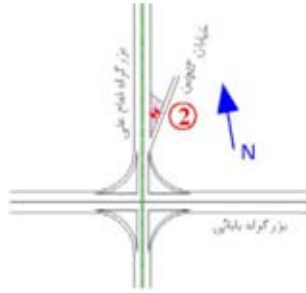
کروکی محل دومین چاهک دستی و گالری های افقی حفر شده در حاشیه بزرگراه امام علی (ع)
