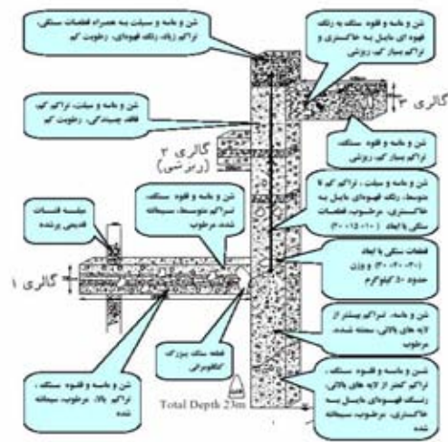
پروفیل خاک در محل شماره ۱ تا عمق ۲۰ متری
