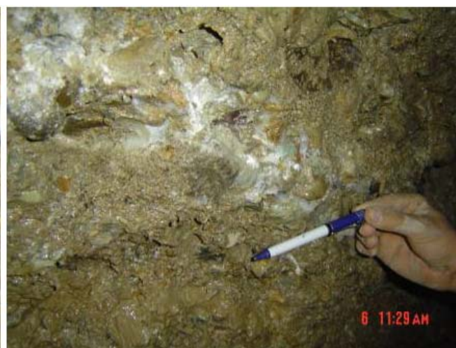
شکل ۲۱- رسوبگذاری کلسیت به صورت ثانویه و متصل کردن دانه‌ها به همدیگر در آبرفت‌های سازند A تهران ( عمق ۷ متری، شمال کوی نصر).
