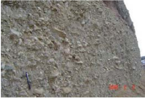
شکل ۳- آبرفتهای سازند B در حوالی دانشگاه شهید بهشتی، متغیر بودن اندازه دانه ها و تیز گوشگی آنها مشخص می باشد (اسفند ۱۳۸۳).
