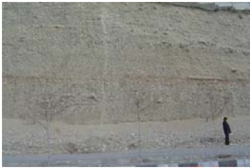
شکل ۴- آبرفتهای سازند B در حوالی دانشگاه شهید بهشتی، ناهمگنی رسوبات و وجود لایه های قرمز بدلیل بالا رفتن میزان رس در این رسوبات مشاهده می شود (اسفند ۱۳۸۳).
