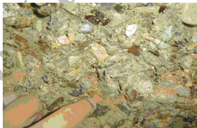
شکل ۲۶- تماس دانه‌ها بصورت تحذب و تقعر و در بعضی قسمت‌ها وجود رس که در بین دانه‌ها قرار گرفته، شکل مربوط به عمق ۱۵ متری و در بزرگراه رسالت (حوالی میدان آرژانتین) میباشد
