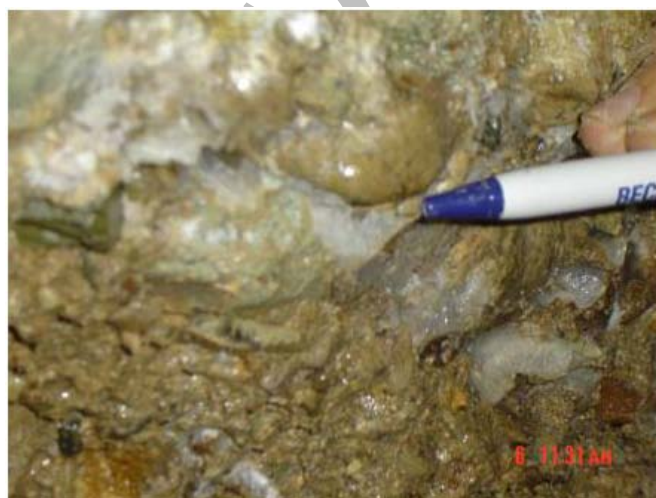
شکل ۲۱- رسوبگذاری کلسیت به صورت ثانویه و متصل کردن دانه‌ها به همدیگر در آبرفت‌های سازند A تهران ( عمق ۷ متری، شمال کوی نصر).
