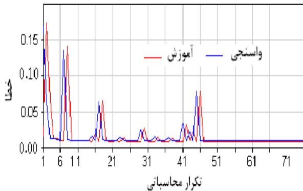
شکل شماره (۶): روند تغییرات خطای شبکه عصبی مصنوعی در تخمین نیترات نسبت به تکرار محاسبات در آرایش اول از نرم افزار NeuroSolution
