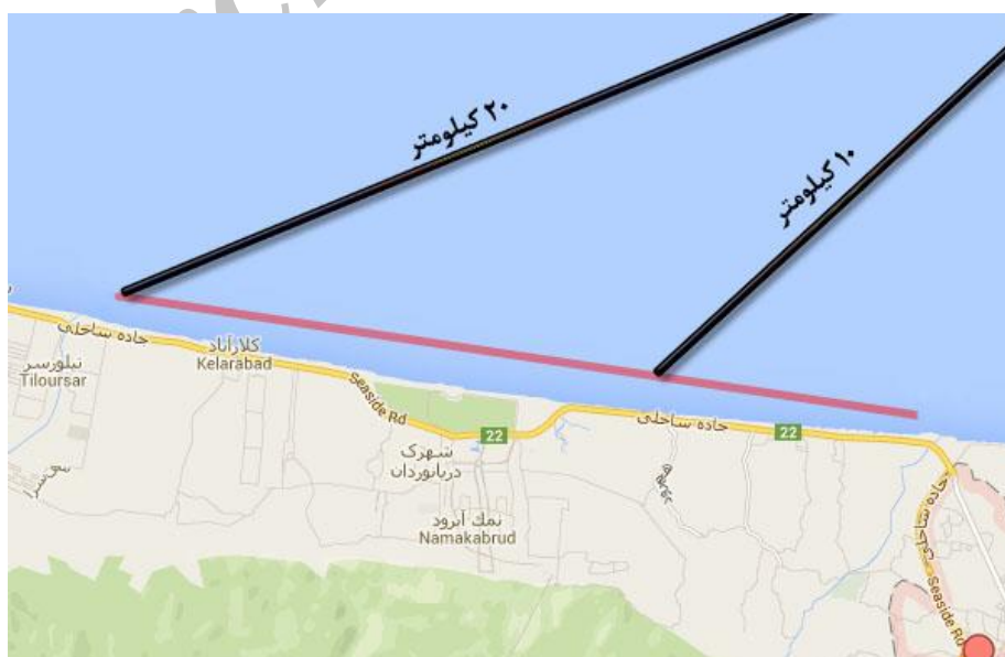
شکل ۱۲. پلان محل برخورد فاضلاب تخلیه‌شده به ساحل در صورت جریانات از شرق به سمت غرب
