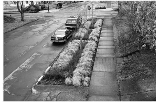
شکل ۵. جمع‌آوری رواناب از سطوح کف‌سازی و هدایت آن به باغچه‌ها به صورت تدریجی و در زمان مورد نیاز
