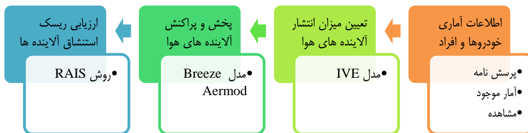
شکل ۲. نمای کلی مراحل ارزیابی ریسک به روش مدل‌سازی
