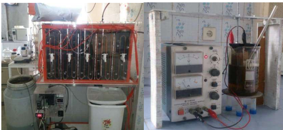
شکل ۱. سمت راست (الف) پایلوت راکتور بافل‌دار بی‌هوازی، سمت چپ (ب) سامانه الکتروشیمیایی پایلوت آزمایشگاهی ناپیوسته
