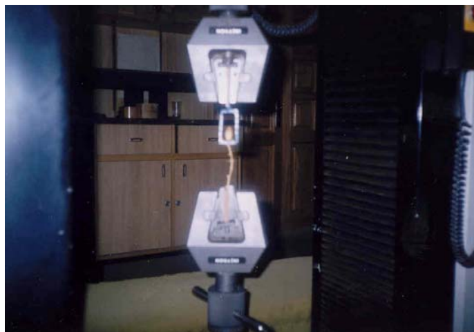
شکل ۲- اتصال مکانیزم مورد استفاده برای کندن غلاف نخود به دستگاه کشش-فشار اینستران.
