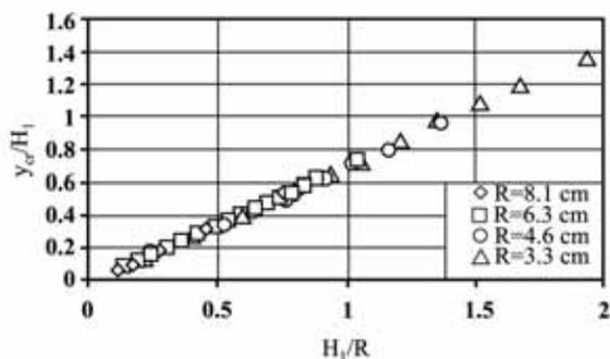
شکل ۱۳- تغییرات عمق نسبی جریان بر روی تاج با بار کل نسبی بالادست در سرریزهای استوانه‌ای.
