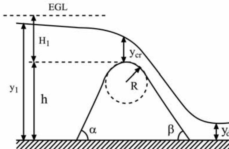
شکل ۱- مشخصات هیدرولیکی و هندسی سرریز تاج دایره‌ای.
