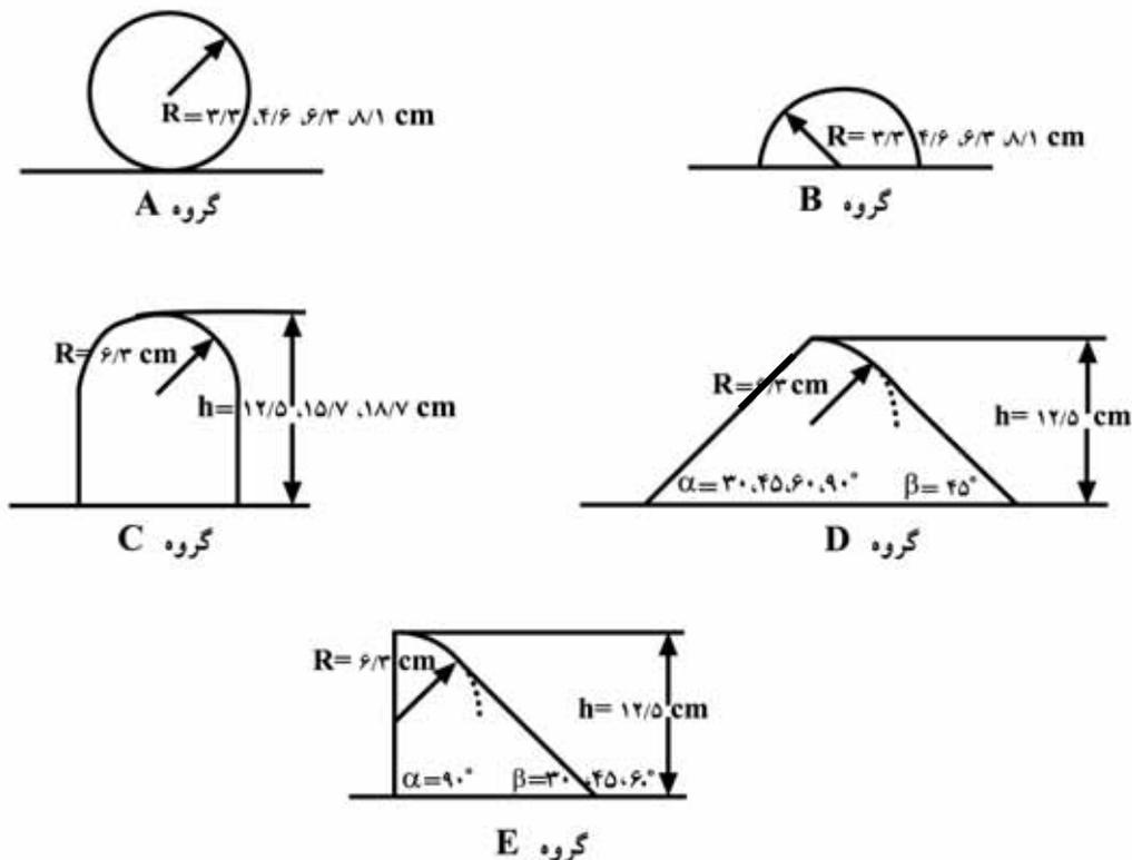
شکل ۲- مشخصات مدل‌های فیزیکی مورد آزمایش
