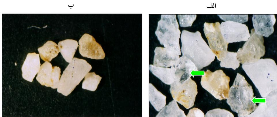
شکل ۵ - تصاویری از نمونه های کوارتزیزر بینوکولر: الف) بیشتر زاویه دار و فلش‌ها مشخص کننده بافت هاله مانند، بزرگنمایی ۲۴ برابر
