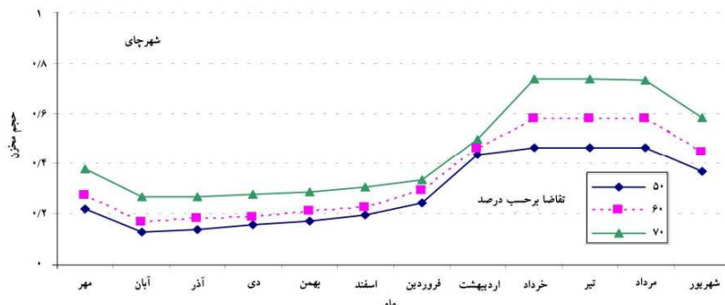
شکل ۴- تغییرات حجم ذخیره نسبت به ماه‌های مختلف برای قابلیت اعتماد زمانی و آسیب پذیری مشخص در تقاضاهای مختلف در سایت شهرچای.
