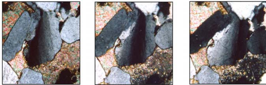
شکل ۴ خاموشی جارویی شدید، از چپ به راست نحوه تغییر خاموشی به خوبی دیده می شود، 10x, XPL
