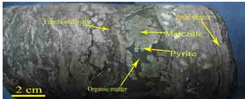
شکل ۱۵ رشد همزمان پیریت و مارکاسیت ویژه کانسارهای لایه‌ای (Startiform). پیریت فرامبوئیدال در متنی از مواد آلی. نواربندی ظریف لایه از کانیهای سولفیدی، شامل اسفالریت و گالن. در این نمونه و نیز، چین‌های دیاژنتیک دیده می‌شود.
