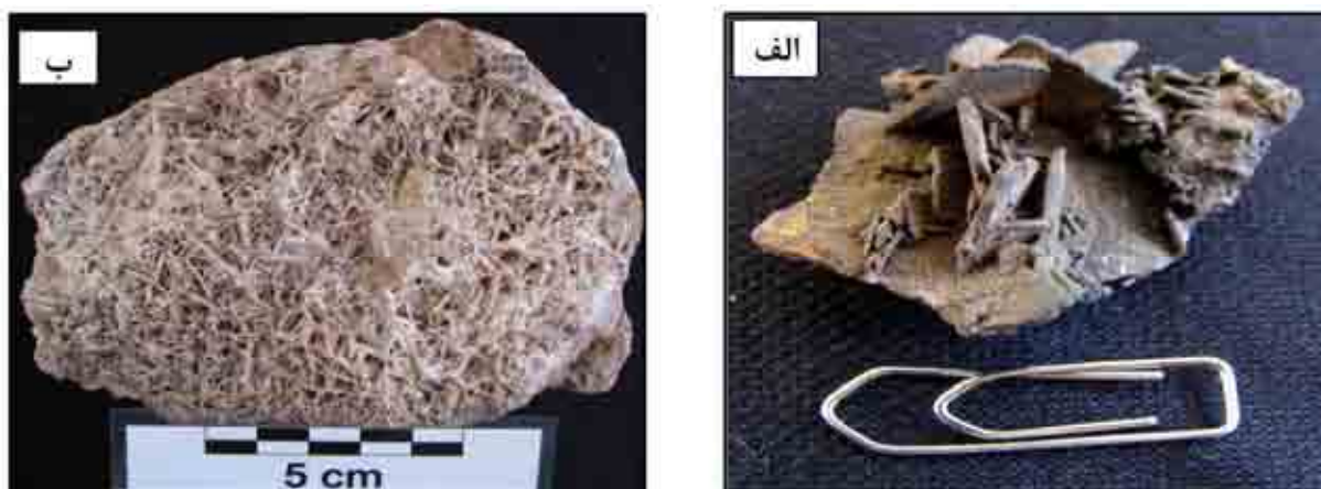
شکل ۱۳ نمونه‌های دستی مربوط به باریت. الف - بافت تیغ‌های باریت همراه با بافت پوششی (Coating) منگنز، ب - بافت جعبه‌ای باریت.
