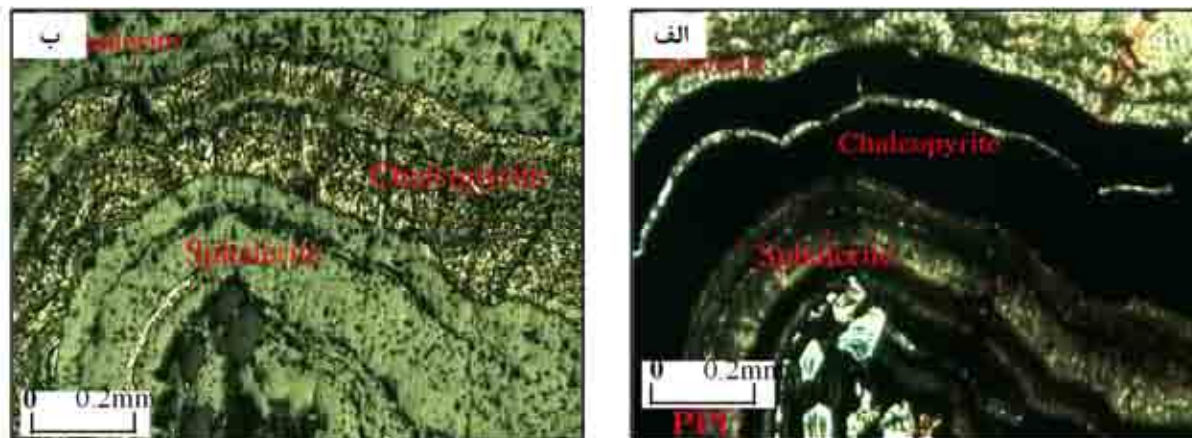
شکل ۷ بافت کلوفرم (ریتمیک) از کانی اسفالریت در نور PPL عبوری در الف و نور بازتابی در ب.
