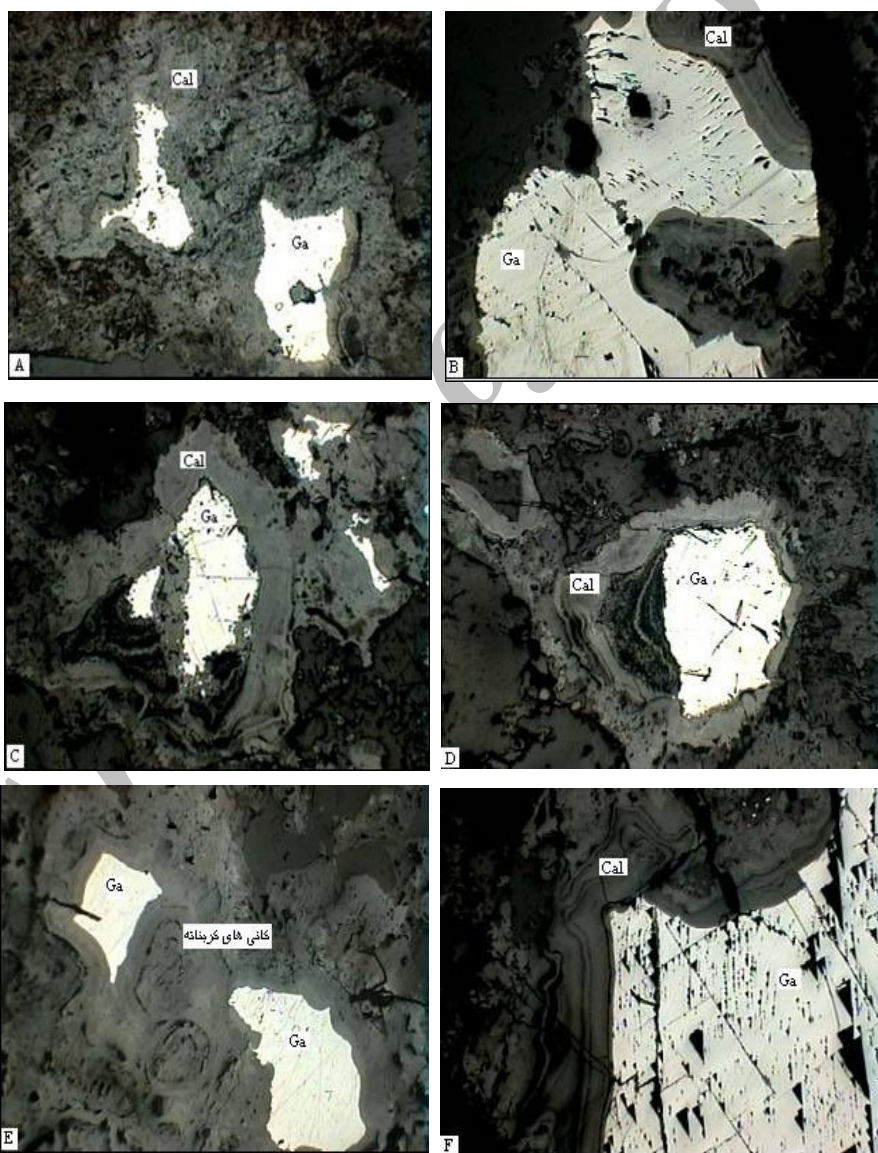
شکل ۴ تصاویر A, B, C, D, E, F، بافت جانیشینی را در اطراف بلورهای گالن نشان می‌دهد. کانی‌های کربناته از جمله کلسیت، دولومیت و سروزیت جانشین گالن شده‌اند. (بزرگنمایی ۴۰). Ga=گالن. Cal=کلسیت.
