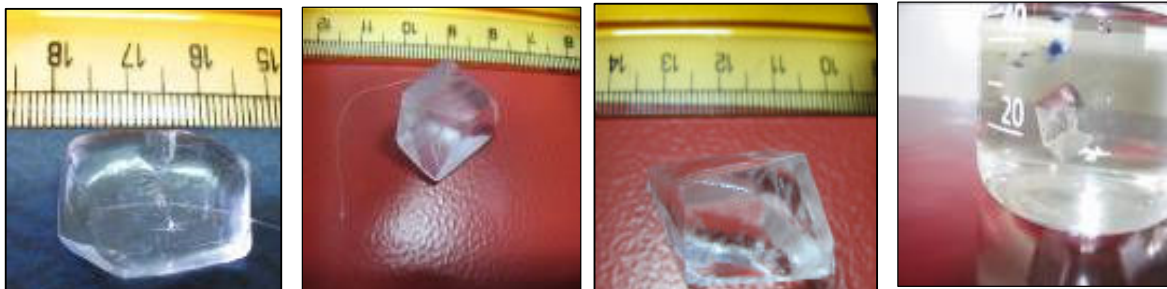
شکل ۷. بلورهای رشد داده شده با سمت بندی‌های مختلف دانه اولیه.
