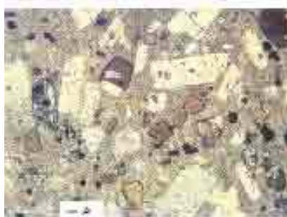
تصویر ۴ بافت پورفیری در داسیت حاوی درشت بلورهای پلاژیوکلاز (Plg) و بیوتیت (Bio) در خمیره ریز دانه تا مخفی بلور (PPL).
