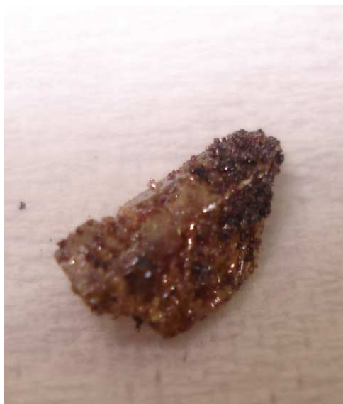
شکل ۵ بس بلور ZnS_{0.5}Se_{0.5} رشد یافته در دمای 782^{\circ}C .
