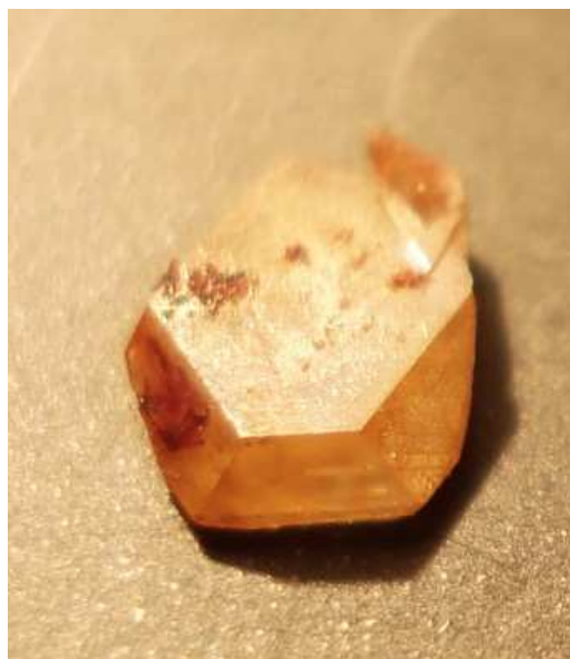
شکل ۴ تک بلور ZnS_{0.5}Se_{0.5} رشد یافته در دمای بهینه ( 882^{\circ}C ).
