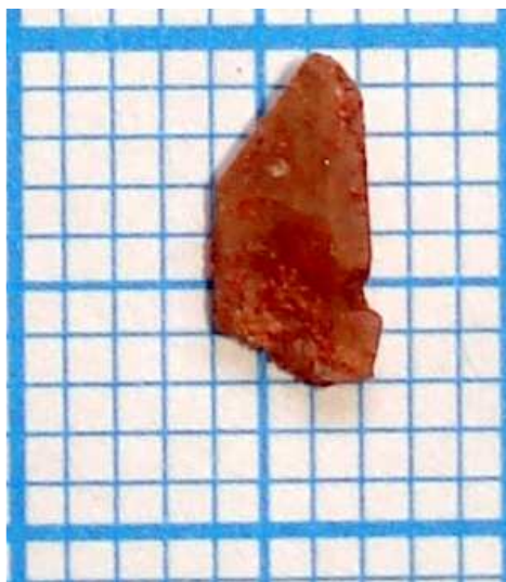
شکل ۶ بس بلور ZnS_{0.5}Se_{0.5} رشدیافته در دمای 982^{\circ}C .
