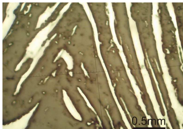
شکل ۴ بافت زین‌اسبی در استینیت‌های رگه شماره ۲ در برش صیقلی در PPL. رگه‌های استینیت با رنگ سفید مایل به خاکستری در بستر باطله سیلیسی قرار دارد.
