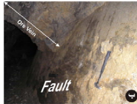
شکل ۴ الف) رگه‌ی اصلی حاوی گالن، اسفالریت و کلسیت در کانسار ارم کوچک که در راستای گسل شمال غربی-جنوب شرقی تشکیل شده است. B- رخنمونی از رگه‌ی کانهدار در تونل اصلی کانسار آساران که با گسل کنترل شده است.
