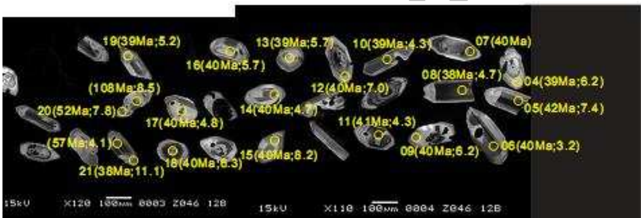
شکل ۹ تصویر CL (کاتد لومینسانس [درخشان]) از ۵۷ دانه زیرکن که در قالب مخصوص قرار داده شده و تعداد ۲۰ دانه‌ی مورد سال سنجی قرار گرفته است. نتیجه حاصل برای هر دانه روی آن نوشته شده است.
