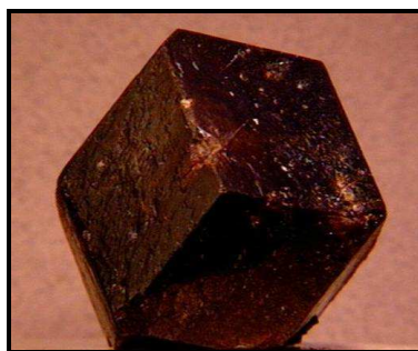
شکل ۳ بلور گارنت با پیکربندی دوازده وجهی خاص {۱۱۰}، اندازه بلور تقریباً ۱۰ میلی متر است.
