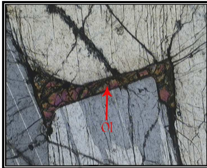
شکل ۹ بلور اینترکومولوس اولیوین که بین بلورهای پلاژیوکلاز متبلور شده است.
