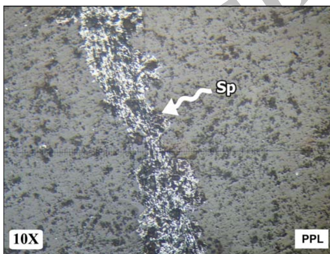
شکل ۱۸ تصویر میکروسکوپ نور بازتابی از رگچه اسپکیولاریت در بلوک صیقلی.
