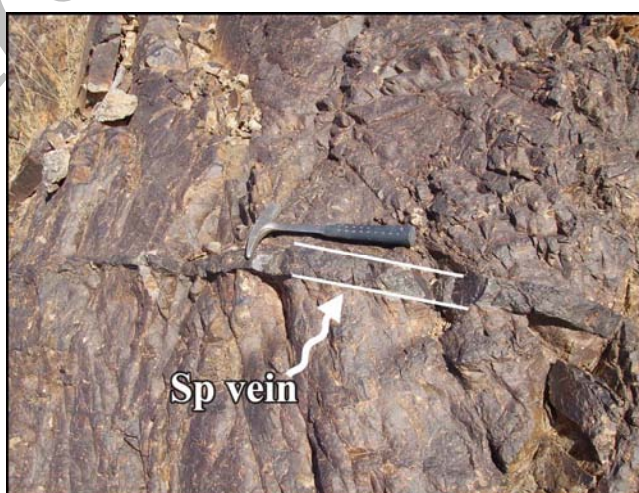
شکل ۱۹ رگه اسپکیولاریت در توده متا هورنبلند مونزودیوریت پورفیری.
