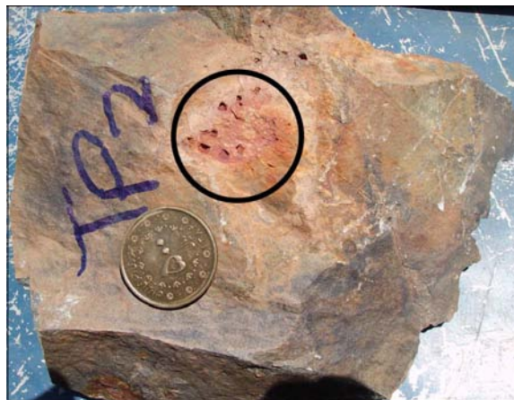
شکل ۱۵. اکسایشی شدن پیریت‌ها و بر جای ماندن قالب آن‌ها.
