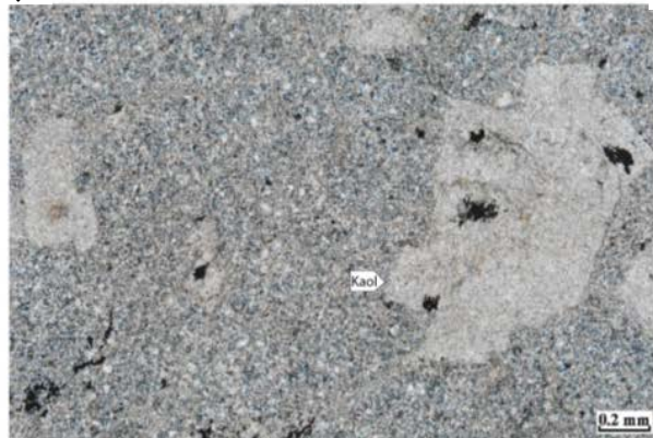
شکل ۲ مقاطع نازک استوک کوارتز مونزونیت پورفیری با دگرسانی‌های (الف) پتاسی، (ب) فیلیک، (پ) آرژیلیک و (ت) پروپیلیتیک.
