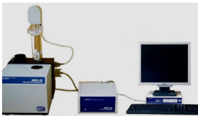
شکل ۳ تصویر دستگاه KLY-3 که برای اندازه‌گیری AMS به کار می‌رود.
