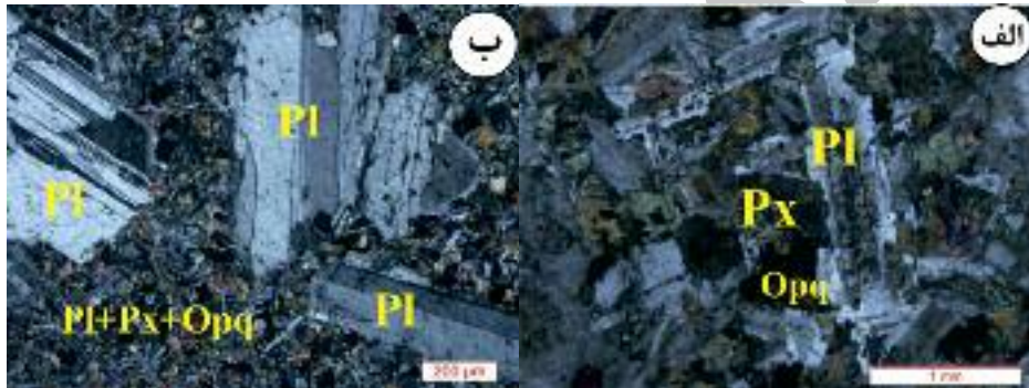
شکل ۴ الف- تصویری از حضور بلورهای پلاژیوکلاز و اوژیت در گابروهای با بافت دانه‌ای. Pl: پلاژیوکلاز، Aug: اوژیت. ب- تصویری از حضور پورفیرهای پلاژیوکلاز در دایک‌های میکروگابرویی با بافت گلومروپورفیری.
