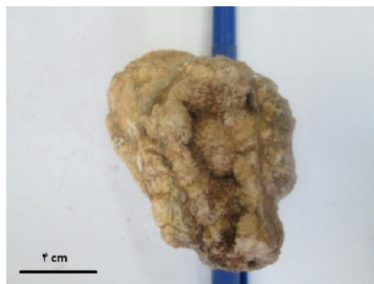
شکل ۱۱ بلورهای کلسیت در زمینه‌ی سنگ کربناتی، کلسیت با بافت رگه‌ای و اسپاری قابل مشاهده است.
