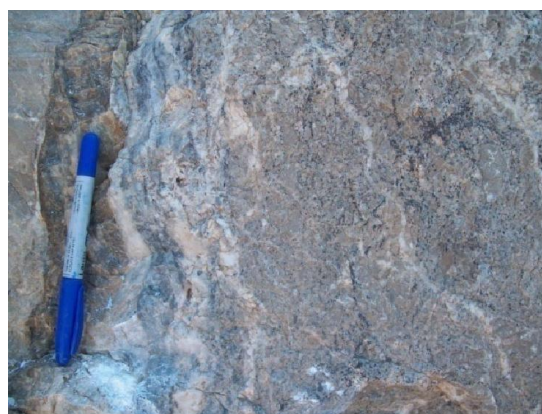
شکل ۱۵ بافت برشی خرد شده شامل قطعات خرد شده سنگ میزبان و سیمان ماده معدنی.
