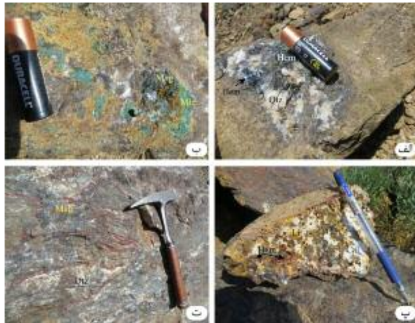
شکل ۲ تصاویر نمونه دستی و صحرایی از انواع کانی‌زایی در ذخیره آهن چالو. الف) کانه‌زایی هماتیت ورقه‌ای به‌صورت بلورهای صفحه‌ای اسپیکولاریت (Hem) و کوارتز (Qtz). ب) اجتماع بلوری یا پوسته‌ای مالاکیت (Mal) همراه با منیتیت (Mag) کالکوپیریت و کلسیت در حفرات؛ هماتیت لیمونیتی شده (Li) و بلورهای کلسیت (Cal) در حفرات؛ ت) کانه‌زایی آهن در راستای لایه بندی توف‌های کربناتی (ساخت نواری). مخفف کانی‌ها از [۱۴].
