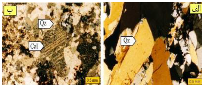
شکل ۳ کوارتز (Qz) و کلسیت (Cal) کانی‌های اصلی و عمده تشکیل‌دهنده رگه‌ها هستند. (نور XPL) علائم کانی‌ها بر اساس مرجع [۱۹].
