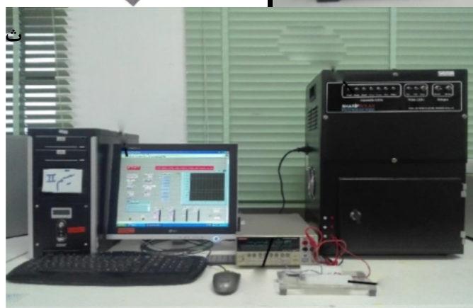
شکل ۲ وسایل مورد استفاده الف- دستگاه لایه‌نشانی چرخشی ب- کوره افقی پ- گرم کننده ت- دستگاه شبیه‌ساز نور خورشید و مشخصه‌یابی جریان-ولتاژ ث- دستگاه کند و پاش.
