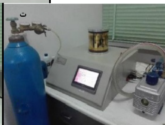
شکل ۲ وسایل مورد استفاده الف- دستگاه لایه‌نشانی چرخشی ب- کوره افقی پ- گرم کننده ت- دستگاه شبیه‌ساز نور خورشید و مشخصه‌یابی جریان-ولتاژ ث- دستگاه کند و پاش.
