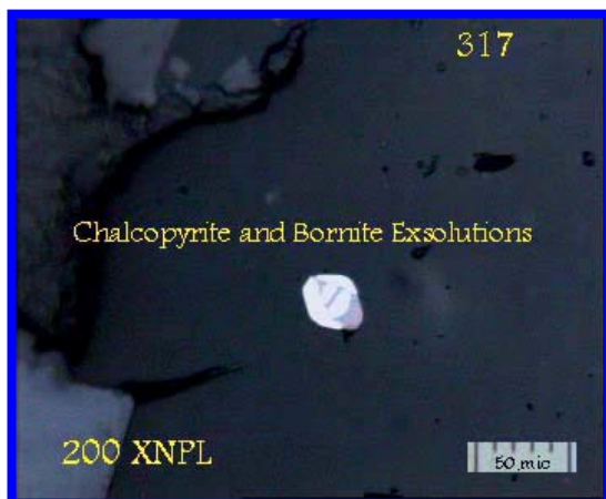
شکل ۳ مقطع صیقلی نمونه به‌دست آمده از منطقه حراران که کانی‌های کالکوپیریت، بورنیت و کوولیت را نشان می‌دهد.
