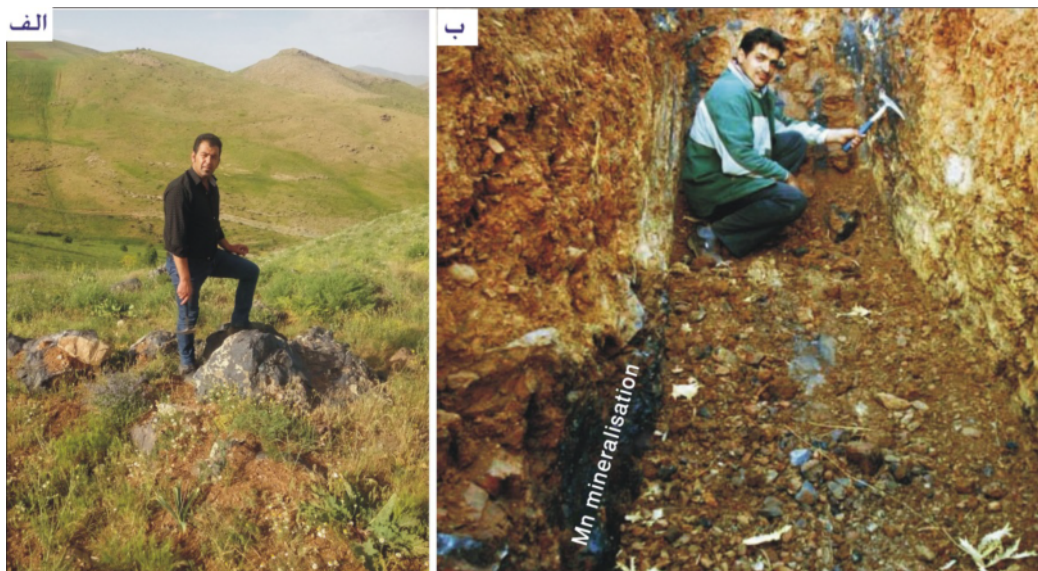
شکل ۴ رخنمون کانسنگ منگنز در سطح زمین (الف) و در ترانشه‌های اکتشافی (ب). قلوه‌ها اغلب از ژاسب و سیلیکات‌های منگنز تشکیل شده‌اند.
