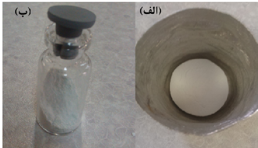
شکل ۲ پودر YCB پس از پایان فرایند گرمایی. (الف) در بوتله پلاتینی. (ب) پس از آسیاب کردن قرص.
